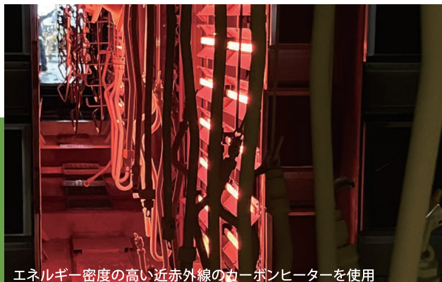
エネルギー密度の高い近赤外線のカーボンヒーターを使用
